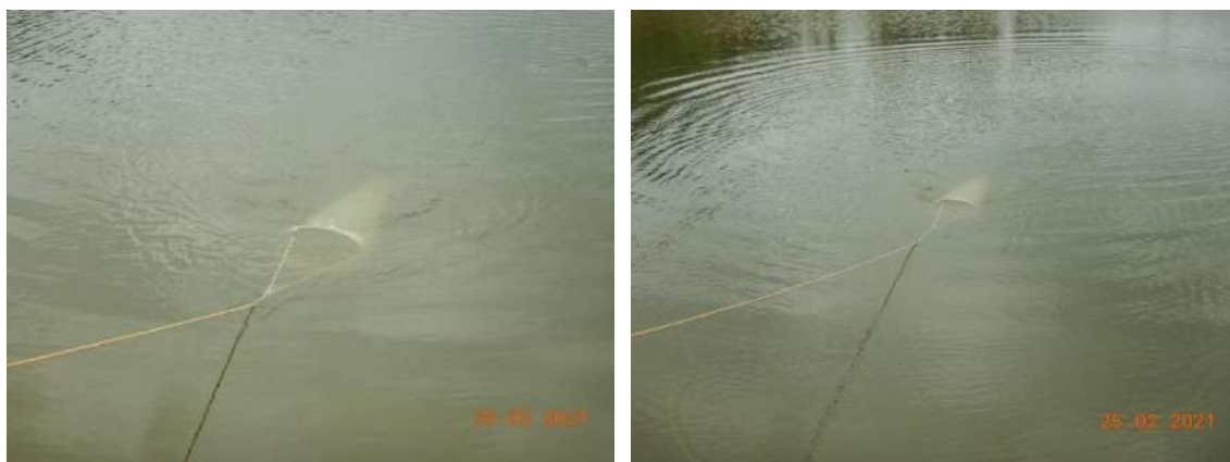
Fotos 3.2.1-1 e 3.2.1-2 Amostragem qualitativa de fitoplâncton com rede de plâncton de 20 µm.
