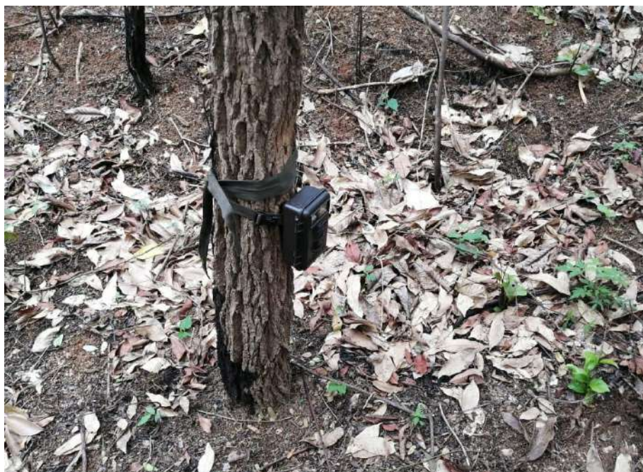
FOTO 4.1-2: Armadilha fotográfica modelo Bushnell HD
